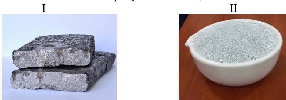
Рисунок 106- Фотографии сплава (А) и возгонов (В) шихты первого состава
