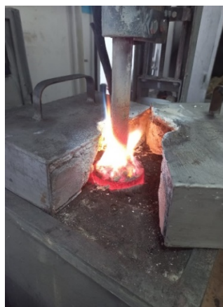
Рисунок 84 – Фрагменты электроплавки хвостов обогащения с рудой
