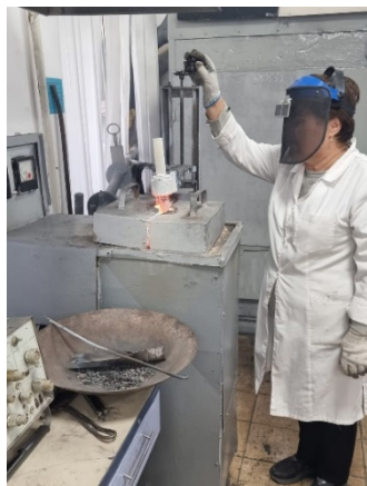
Рисунок 84 – Фрагменты электроплавки хвостов обогащения с рудой
