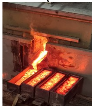
I-розжиг печи, II- загрузка печи шихтой, III-корректировка плавки, IV - V- слив расплава, VI-возгоны рукавного фильтра Рисунок 104- Фрагменты электроплавки руды месторождения Шалкия совместно с хвостами обогащения и стальной стружкой
