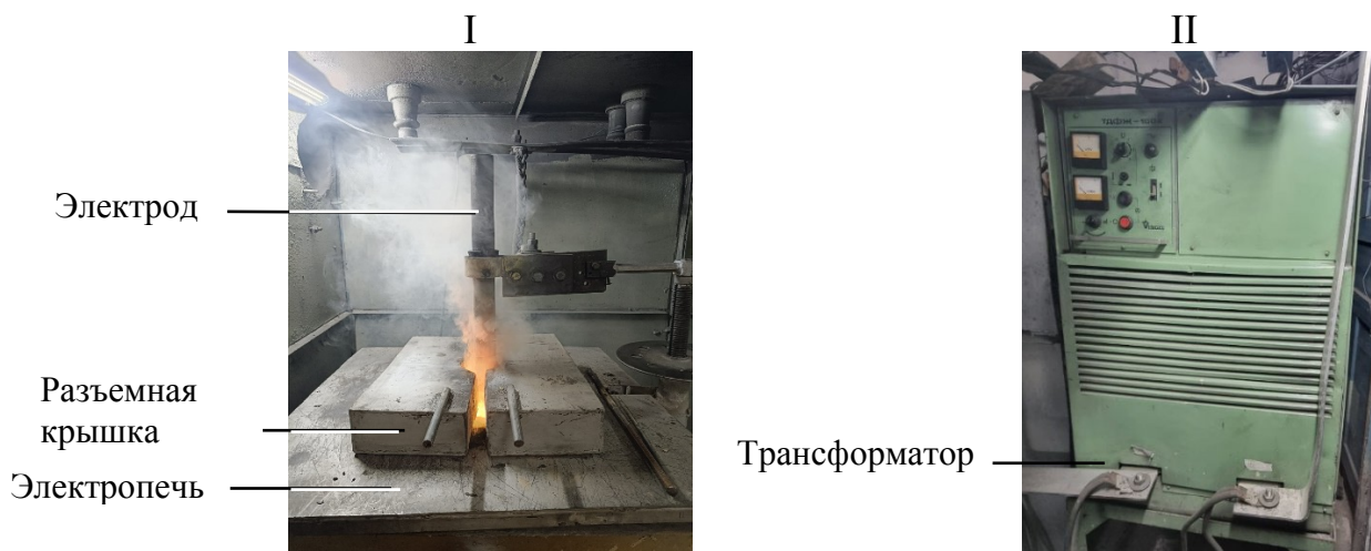
Рисунок 23 - Фотография одноэлектродной дуговой электропечи средней мощности (I) и печного трансформатора (II)
