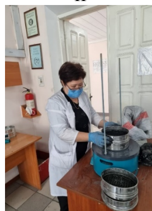
Рисунок 17 - Ситовой анализатор А12 (I) и рассев сырья (II)
