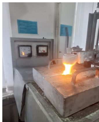
Рисунок 75— Фрагменты электроплавки окисленной руды Шалкия
