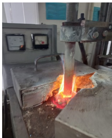
Рисунок 79 - Фотография колошника при плавке руды совместно с магнетитовым концентратом и стальной стружкой при 50% \gamma
