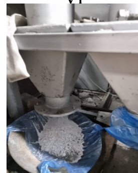
I-розжиг печи, II- загрузка печи шихтой, III-корректировка плавки, IV - V- слив расплава, VI-возгоны рукавного фильтра Рисунок 104- Фрагменты электроплавки руды месторождения Шалкия совместно с хвостами обогащения и стальной стружкой
