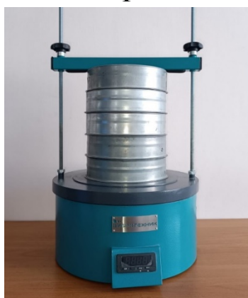
Рисунок 17 - Ситовой анализатор А12 (I) и рассев сырья (II)
