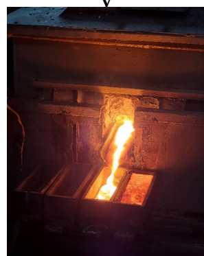
I-розжиг печи, II- загрузка печи шихтой, III-IV -плавка шихты, с замером температуры, V- слив расплава, VI- возгоны рукавного фильтра
