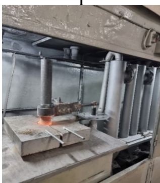
I-розжиг печи, II- загрузка печи шихтой, III-корректировка плавки, IV - V- слив расплава, VI-возгоны рукавного фильтра Рисунок 104- Фрагменты электроплавки руды месторождения Шалкия совместно с хвостами обогащения и стальной стружкой
