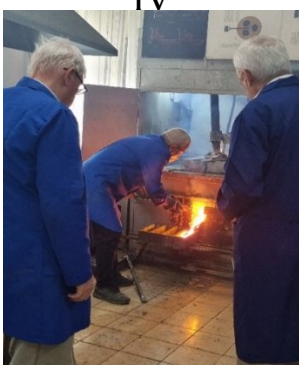
I-розжиг печи, II- загрузка печи шихтой, III-IV -плавка шихты, с замером температуры, V- слив расплава, VI- возгоны рукавного фильтра
