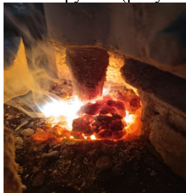
Рисунок 95- Фотография плавки с образованием не активной пены
