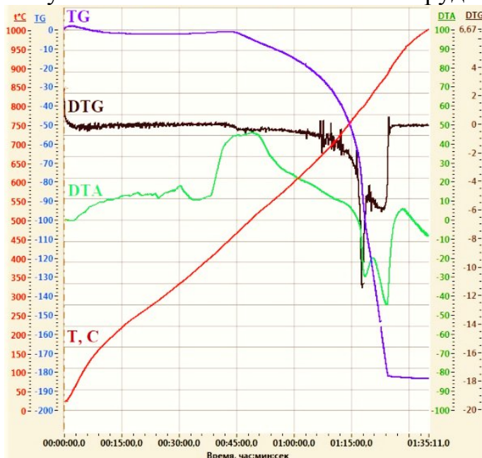
Рисунок 6 -Дериватограмма окисленной руды Шалкия
