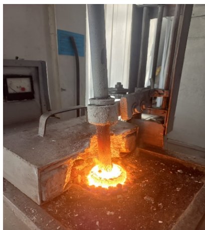
Рисунок 78- Фотография колошника при плавке руды совместно с магнетитовым концентратом
