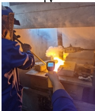
I-розжиг печи, II- загрузка печи шихтой, III-корректировка плавки, IV - V- слив расплава, VI-возгоны рукавного фильтра Рисунок 104- Фрагменты электроплавки руды месторождения Шалкия совместно с хвостами обогащения и стальной стружкой
