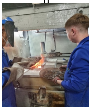
I-розжиг печи, II- загрузка печи шихтой, III-корректировка плавки, IV - V- слив расплава, VI-возгоны рукавного фильтра Рисунок 104- Фрагменты электроплавки руды месторождения Шалкия совместно с хвостами обогащения и стальной стружкой
