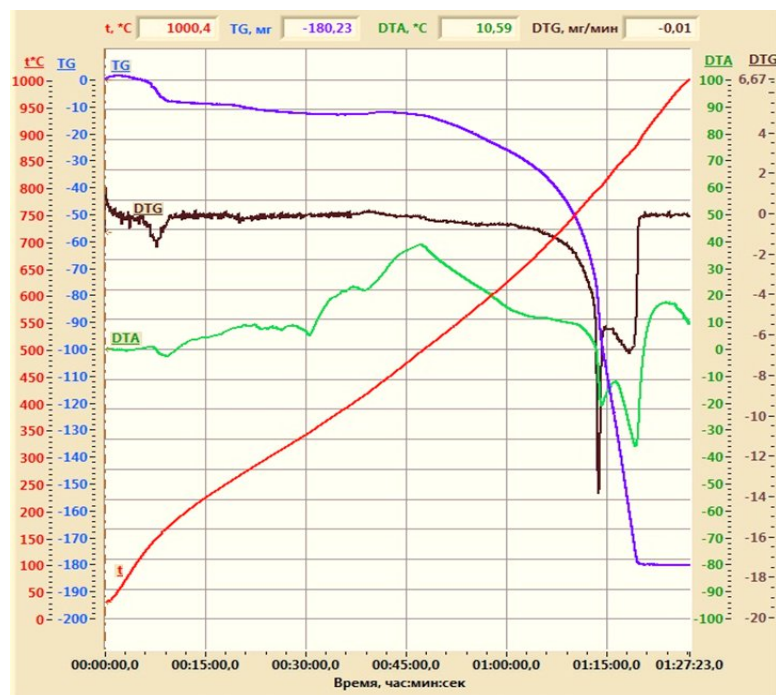
Рисунок 9-Дериватограмма хвостов обогащения руды Шалкия
